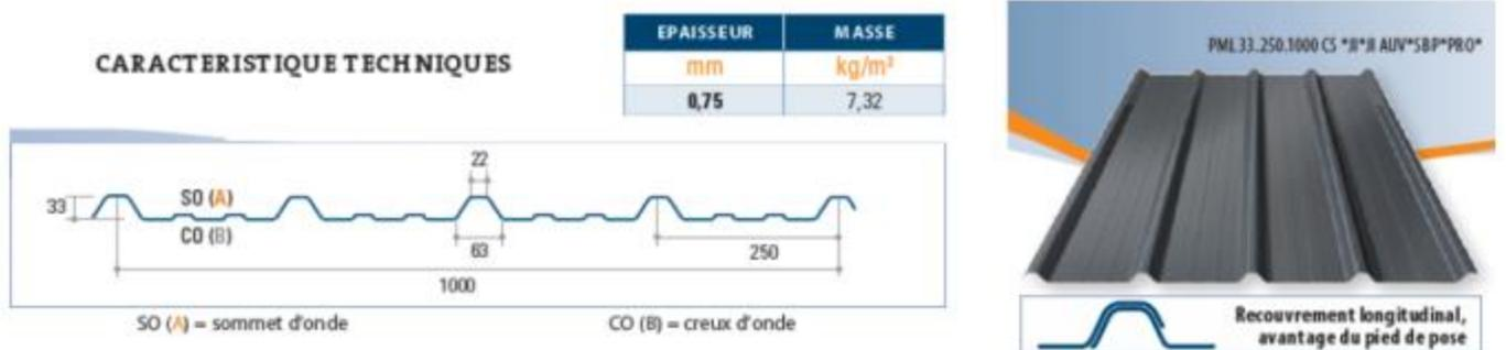
Figure 5 – Profil géométrique des plaques d'acier nervurées JORISIDE pour couverture partielle
