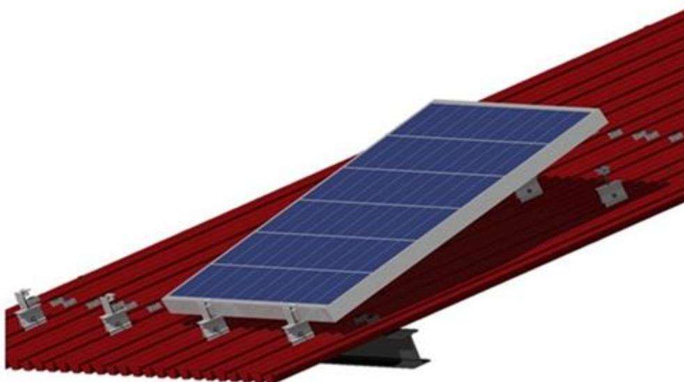
Vérifier que les pare-closes sont bien centrées dans les crochets, puis serrer les vis des pinces de fixation maintenant la partie basse du module (couple de serrage de 15Nm)
